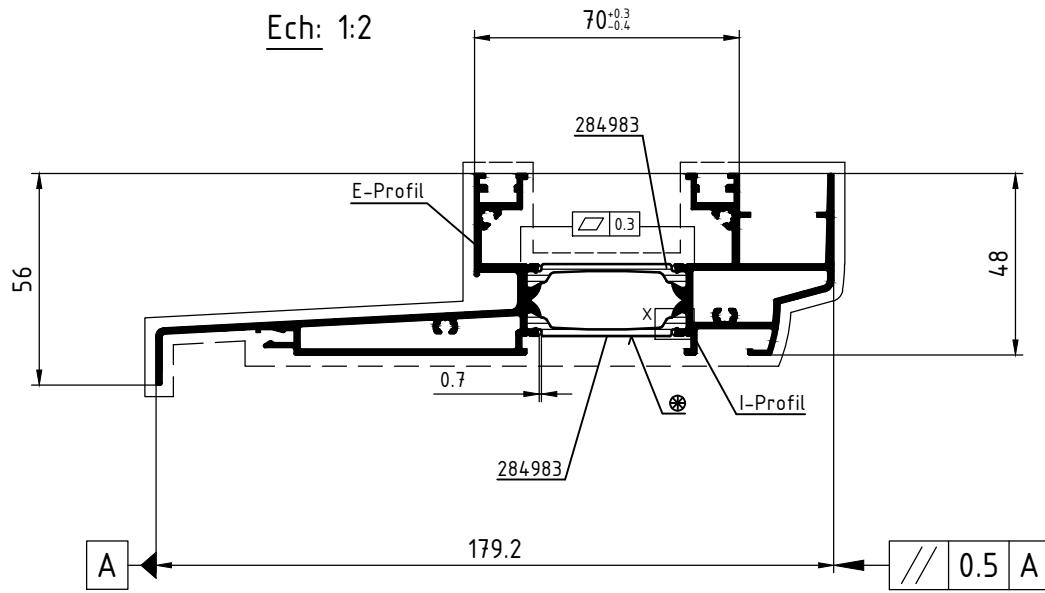
Attention : Le résultat du procédé de sertissage doit être vérifié sur la base des dimensions de référence dans ce plan de rouleaux. Veuillez noter les conseils de vérification dans le manuel actuel de rouleaux.
