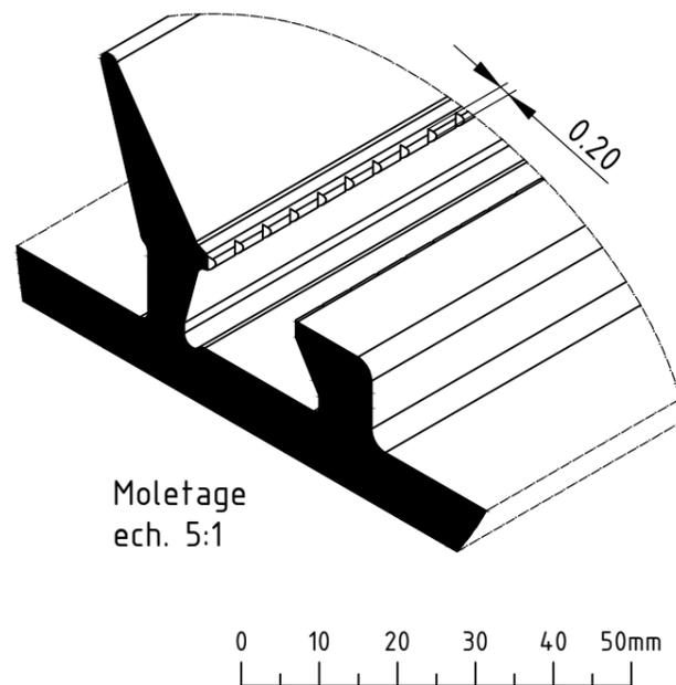
Il est nécessaire de cranter les gorges des barrières isolantes avant de les insérer
