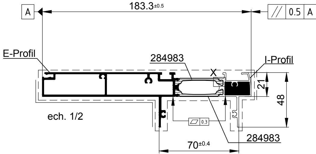
Attention : Le résultat du procédé de sertissage doit être vérifié sur la base des dimensions de référence dans ce plan de rouleaux. Veuillez noter les conseils de vérification dans le manuel actuel de rouleaux.
