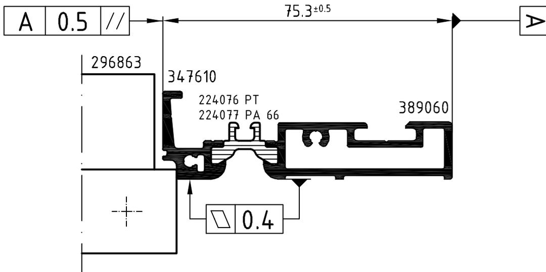
N.B. Posizionare il rullo SA1 (296863) sul gradino interno del profilo.
