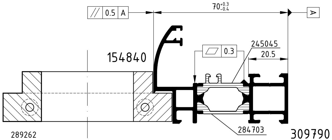
Attention : Le résultat du procédé de sertissage doit être vérifié sur la base des dimensions de référence dans ce plan de rouleaux. Veuillez noter les conseils de vérification dans le manuel actuel de rouleaux.
