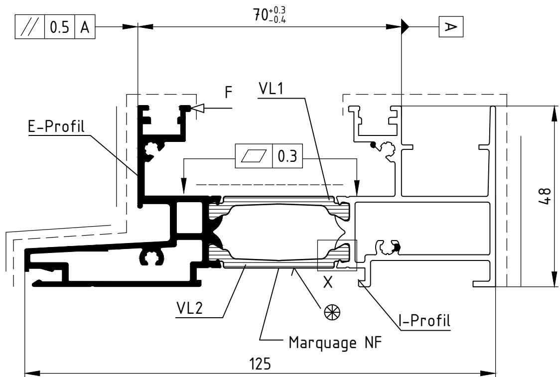
Attention : Le résultat du procédé de sertissage doit être vérifié sur la base des dimensions de référence dans ce plan de rouleaux. Veuillez noter les conseils de vérification dans le manuel actuel de rouleaux.
