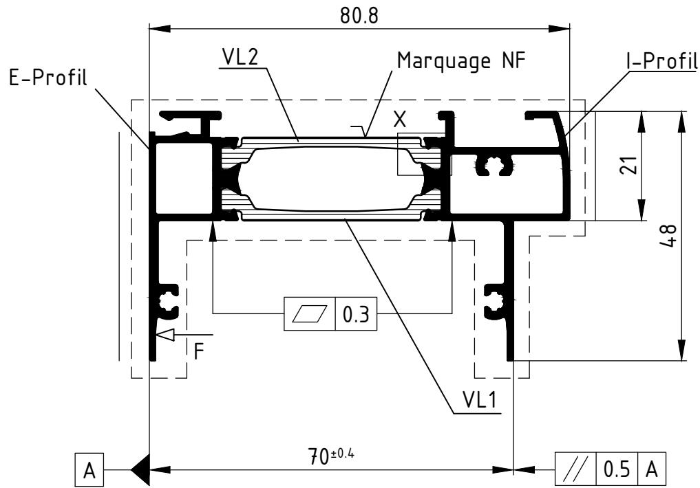
Attention : Le résultat du procédé de sertissage doit être vérifié sur la base des dimensions de référence dans ce plan de rouleaux. Veuillez noter les conseils de vérification dans le manuel actuel de rouleaux.
