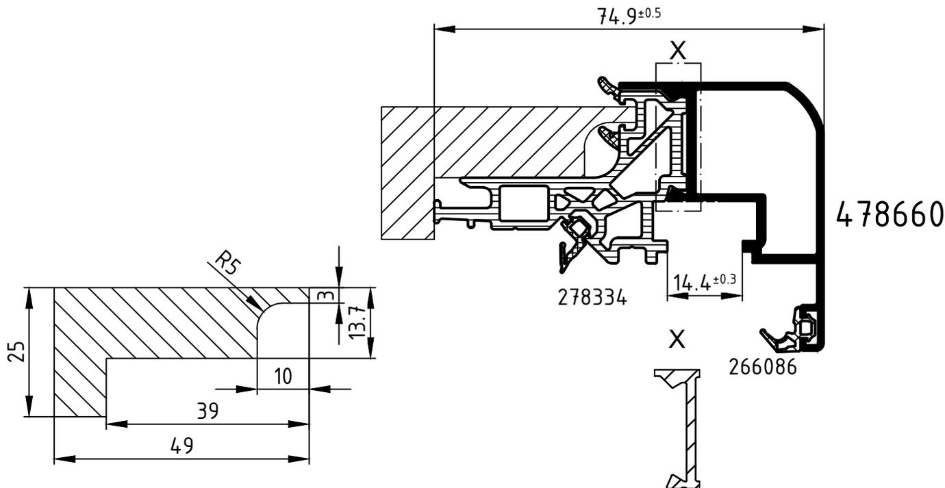
Rollbeilage in Eigenfertigung 2x3600mm
