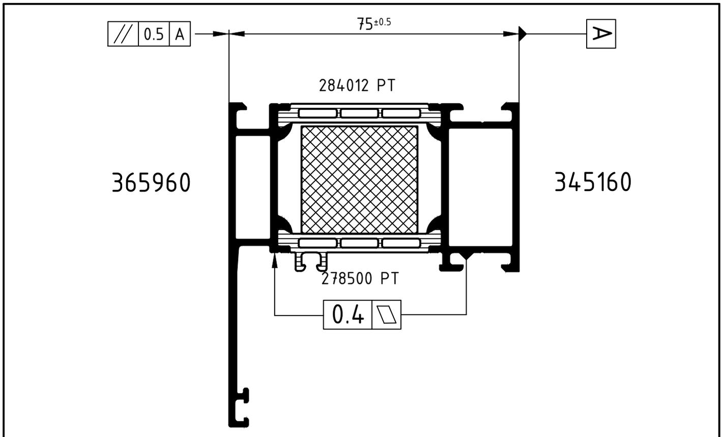
**Achtung:** Das Rollergebnis ist nach dem Verbund des Profiles anhand der Prüfmaße im Rollenplan zu kontrollieren!
