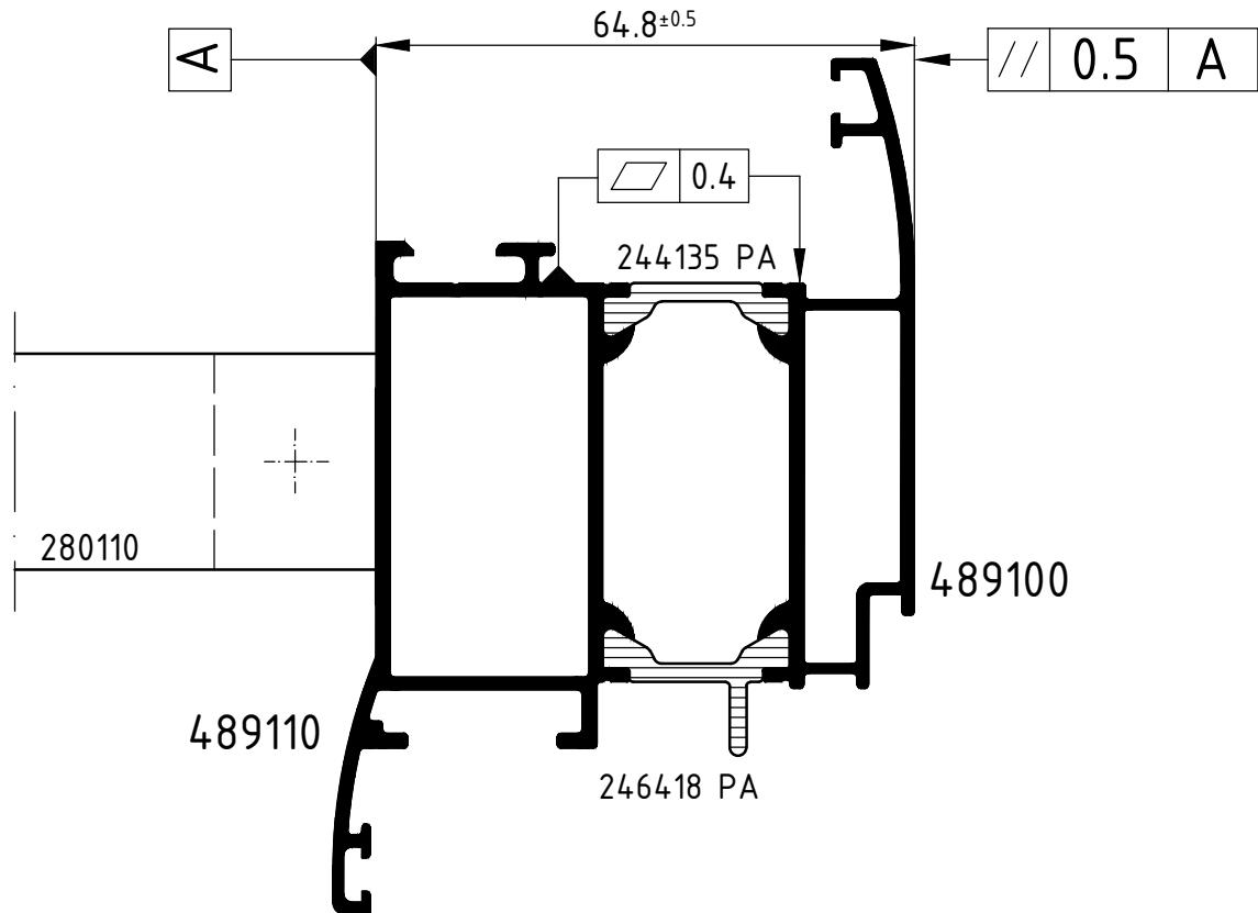
Attention : Le résultat du procédé de sertissage doit être vérifié sur la base des dimensions de référence dans ce plan de rouleaux. Veuillez noter les conseils de vérification dans le manuel actuel de rouleaux.
