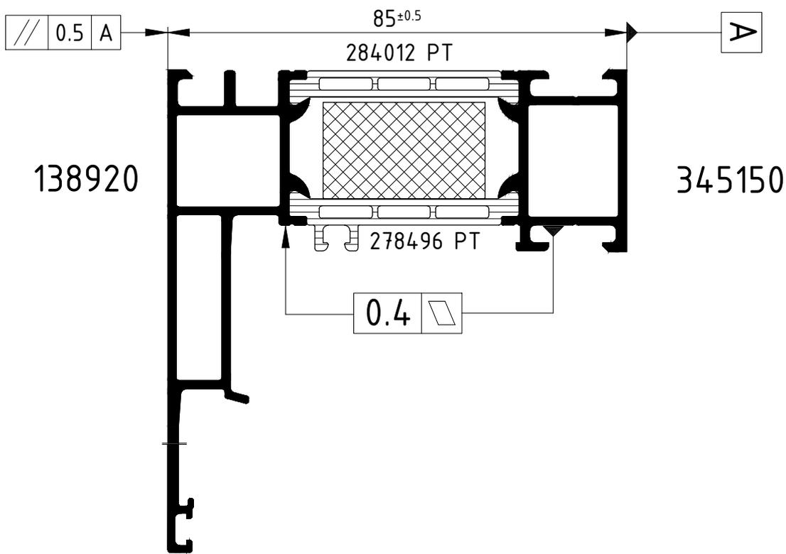
**Achtung:** Das Rollergebnis ist nach dem Verbund des Profiles anhand der Prüfmaße im Rollenplan zu kontrollieren!
