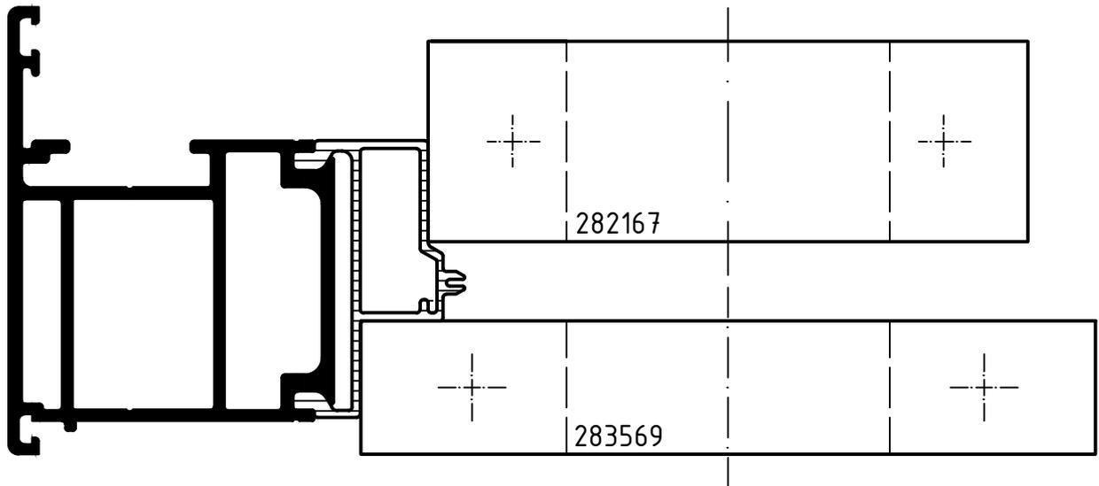
**Attention :** Le résultat du procédé de sertissage doit être vérifié sur la base des dimensions de référence dans ce plan de rouleaux. Veuillez noter les conseils de vérification dans le manuel actuel de rouleaux.
