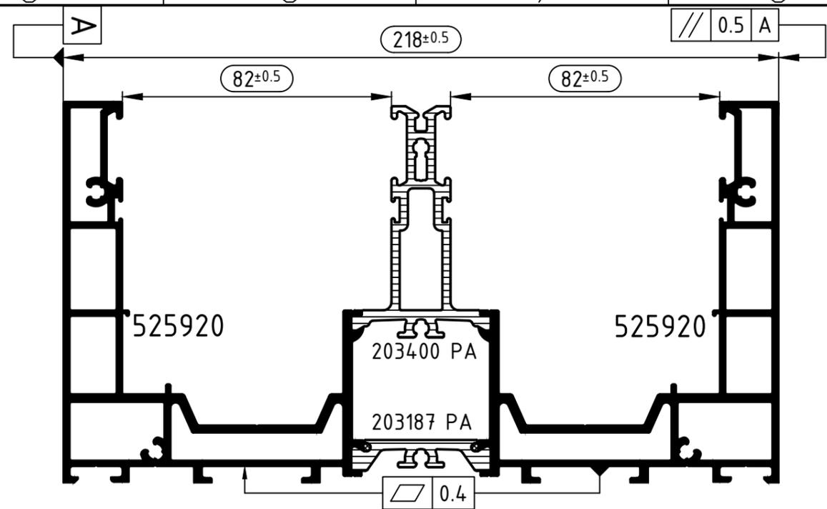
Profil in 2 Durchgängen rollen. 2. Durchgang, Profil zur Querachse 180° drehen.
