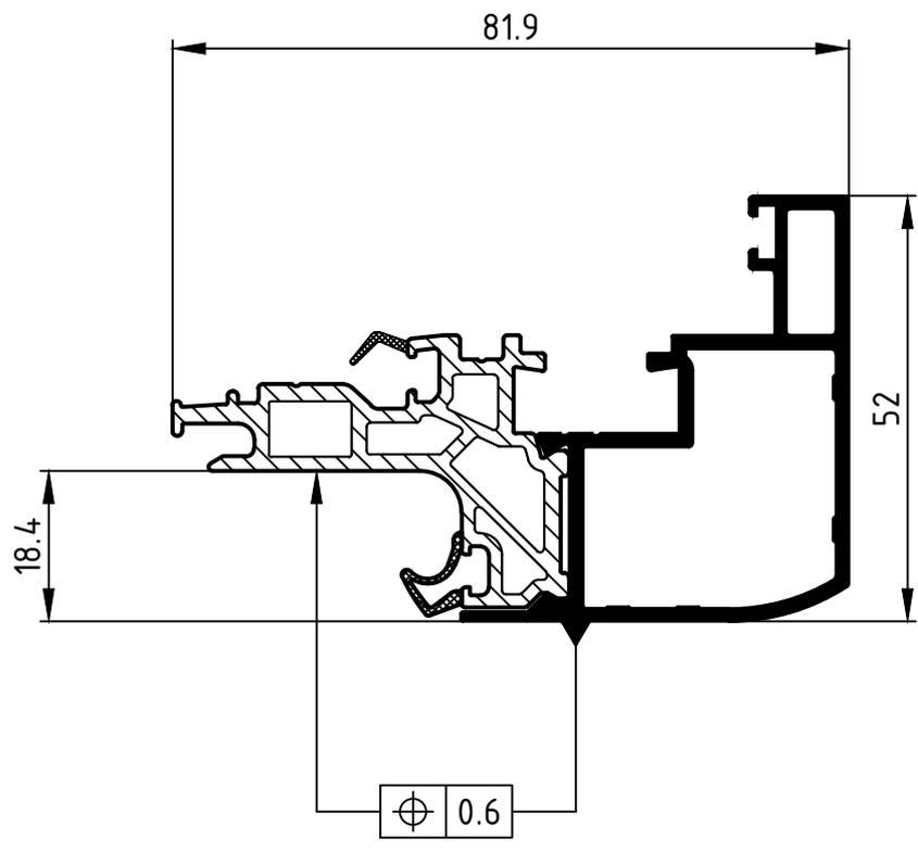
**Attention :** Le résultat du procédé de sertissage doit être vérifié sur la base des dimensions de référence dans ce plan de rouleaux. Veuillez noter les conseils de vérification dans le manuel actuel de rouleaux.
