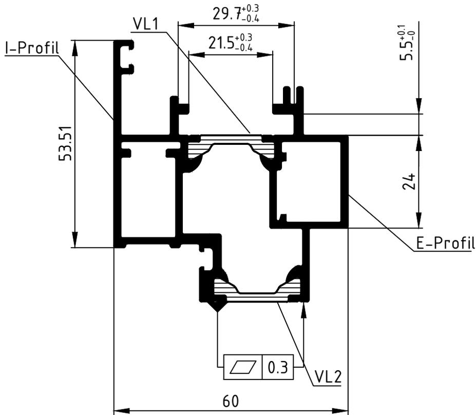
**Attention :** Le résultat du procédé de sertissage doit être vérifié sur la base des dimensions de référence dans ce plan de rouleaux. Veuillez noter les conseils de vérification dans le manuel actuel de rouleaux.
