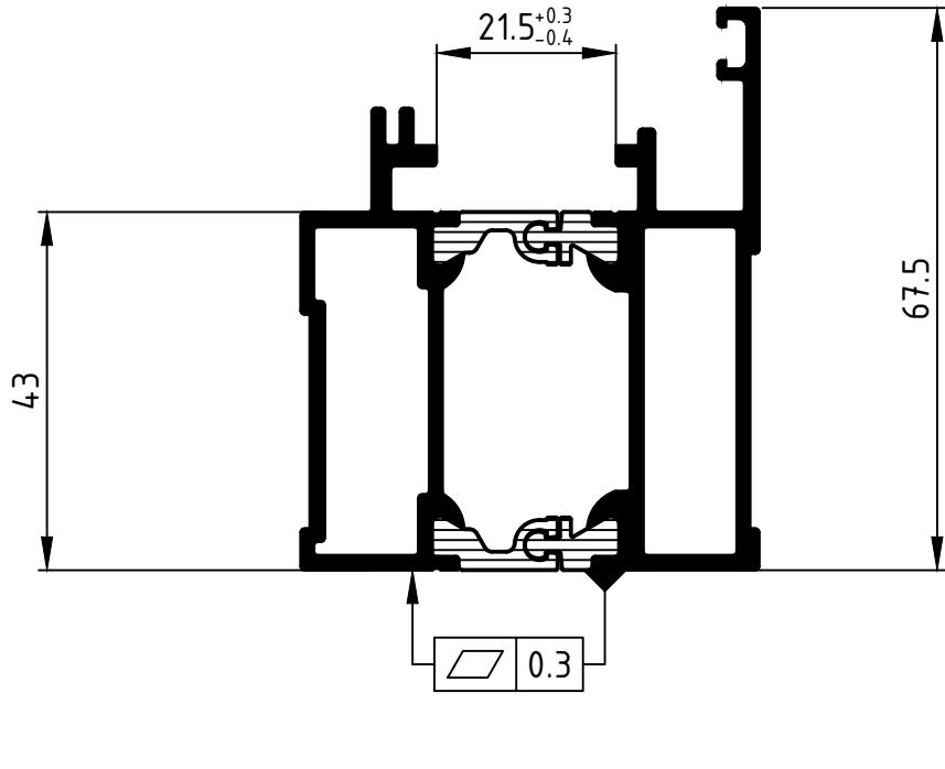
Attention : Le résultat du procédé de sertissage doit être vérifié sur la base des dimensions de référence dans ce plan de rouleaux. Veuillez noter les conseils de vérification dans le manuel actuel de rouleaux.
