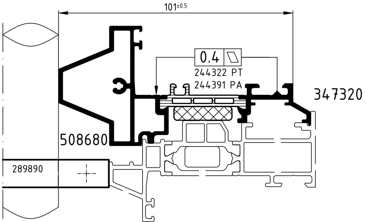
Gerolltes Flügelprofil 523220 als Gegenlager einsetzen
