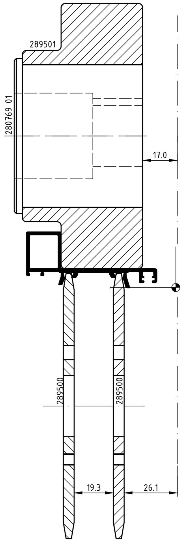
Il est nécessaire de cranter les gorges des barrières isolantes avant de les insérer
