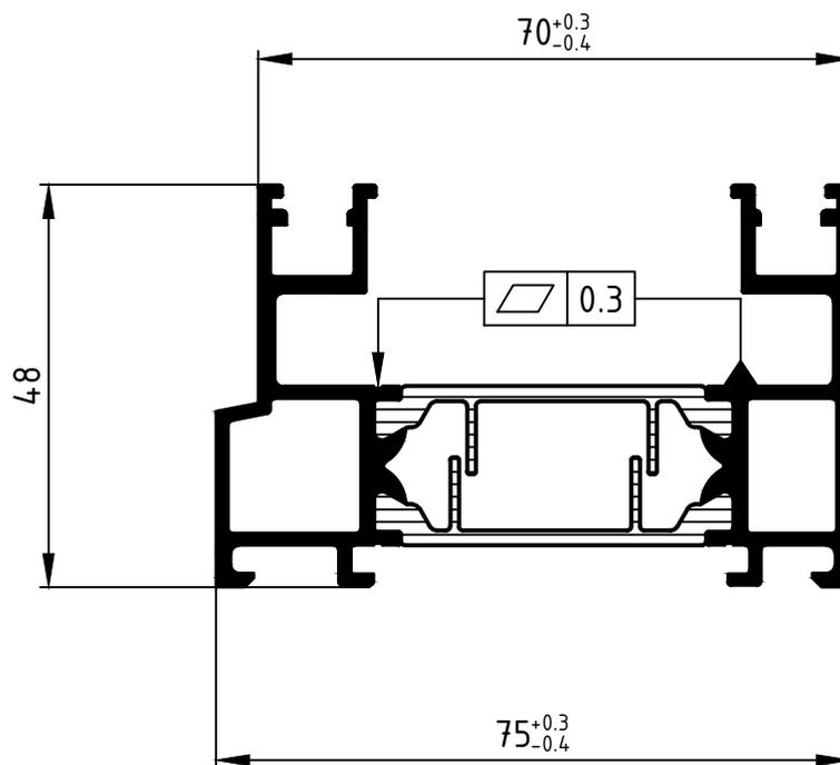
**Attention :** Le résultat du procédé de sertissage doit être vérifié sur la base des dimensions de référence dans ce plan de rouleaux. Veuillez noter les conseils de vérification dans le manuel actuel de rouleaux.
