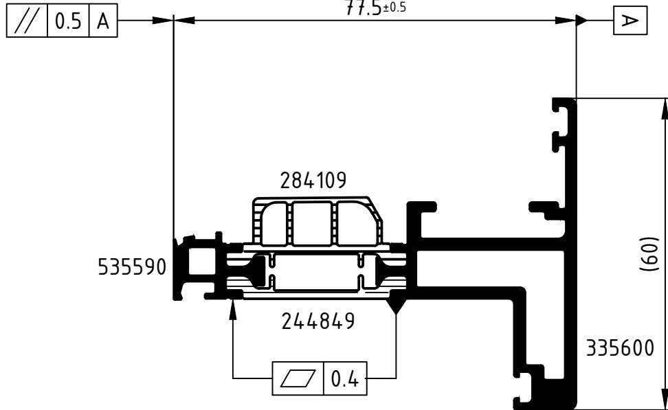
Attention : Le résultat du procédé de sertissage doit être vérifié sur la base des dimensions de référence dans ce plan de rouleaux. Veuillez noter les conseils de vérification dans le manuel actuel de rouleaux.
